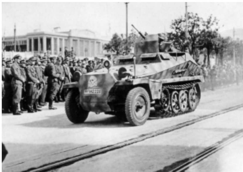
Sd.Kfz. 253, versione comando per reparti di Sturmgeschütze modificato con un'ampia scudatura a protezione della mitragliatrice italiana Fiat 35 dietro alla quale è stato montato un ripiano orizzontale da utilizzare probabilmente per spiegare carte geografiche. Interessante e insolita è la grossa Totenkopf dipinta sulla corazzatura frontale e il faro aggiuntivo non schermato montato anteriormente. Questo mezzo è con tutta probabilità lo stesso conservato tutt'ora, purtroppo in cattive condizioni, a Trieste nella collezione De Henriquez: si tratta anch'esso di un Sd.Kfz. 253 dotato del grosso scudo della mitragliatrice e del ripiano per la stesura delle carte in tutto e per tutto identici a quelli dell'esemplare illustrato nella foto.
